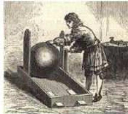
Le frottement de la main sur une boule de soufre crée une séparation des charges électriques.
